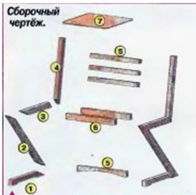
Берем брус из твёрдой древесины и распускаем его на четырнадцать
